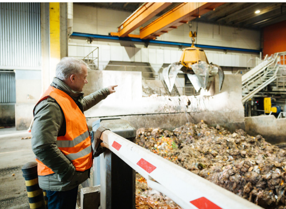
Så här ser matavfallet ut innan det blir så kallad slurry, en av komponenterna i produktionen av biogas och växtnäring.
